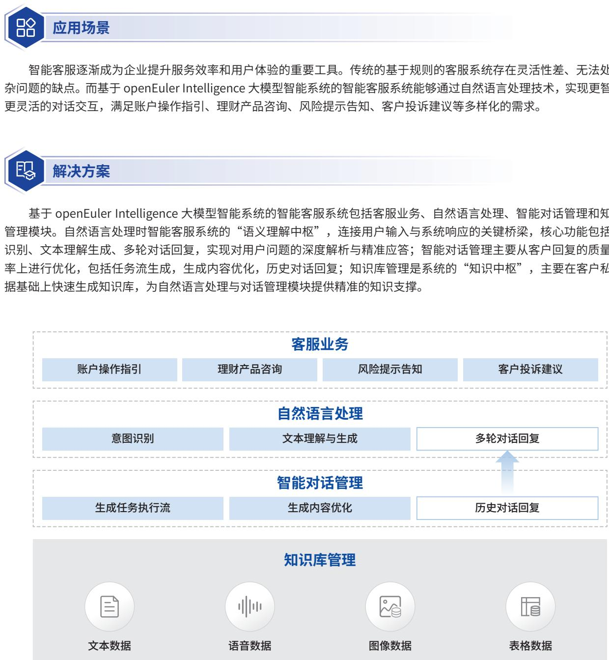
自然语言处理主要包括意图识别、文本理解生成和多轮对话回复。意图识别分析客户输入的文本内容，快速识别其具体的问题类型，自动匹配该问题对应的知识库、预设 prompt 模板或者标准化解决流程，同时也可以引导用户进一步说明问题，确保意图识别的准确性；文本理解生成依托检索增强生成技术，在用户问题解析的基础上，解释知识库数据生成符合业务场景的专业回复，并且综合多轮信息生成连贯、精准的解答。
